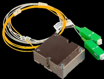
RF-over-fiber (RoF) アナログ光トランシーバ
