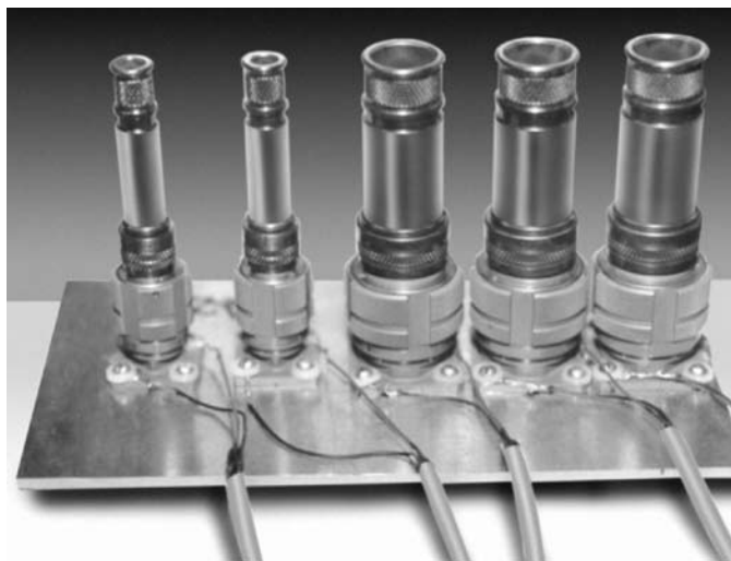
Il test dei connettori è progettato per simulare velocemente un utilizzo esteso nel tempo. I test ambientali, meccanici ed elettrici vengono condotti per misurare sia l'affidabilità dei connettori che del sistema. Il criterio basilare per valutare l'affidabilità è un cambiamento nella resistenza del contatto.
