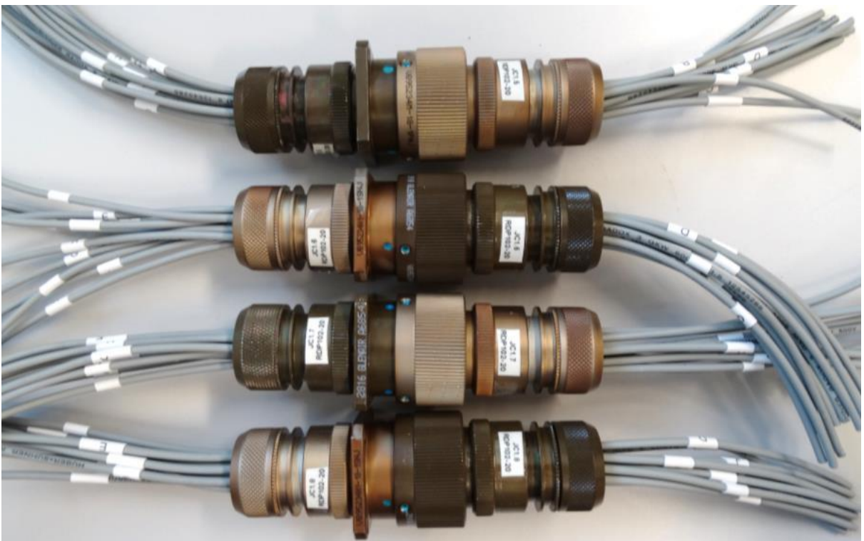
Prüflinge, die bei Glenair geprüft wurden / Connector which are tested by Glenair JC1.5 – JC1.8
