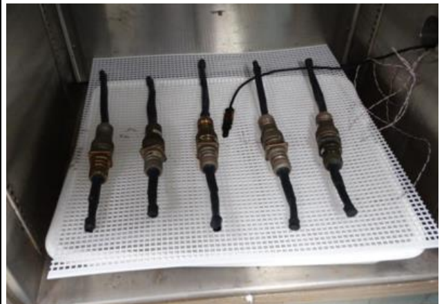
Prüfaufbau für feuchte Wärme / Test setup humidity
